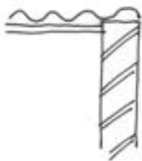
bestaande situatie - ongeïsoleerd
