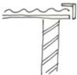
bestaande situatie - ongeïsoleerd
