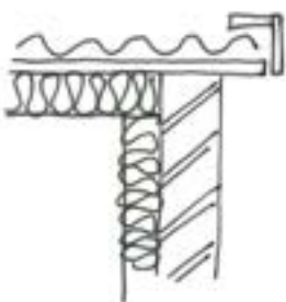
isoleren aan de binnenzijde
